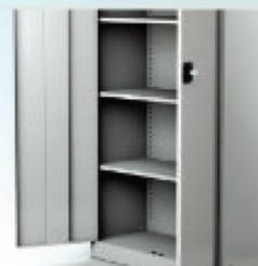
Dveře jsou otočené uložené na masivních kovových čepech. Úhel otevření je cca 100°. Na vnitřní straně dveří je umístěn výztužní profil. Uzamykání je řešeno cylindrickým zámkem s otočnou rukojetí a tříbodovým zamýkacím mechanismem.
